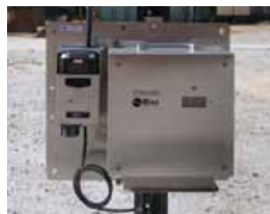
PowerPak in Verbindung mit MeshGuard-Überwachung. Die Überwachungseinheit wird in einem Edelstahl-Schutzgehäuse gezeigt, das mit im Lieferumfang enthaltenen Elementen befestigt wurde.
