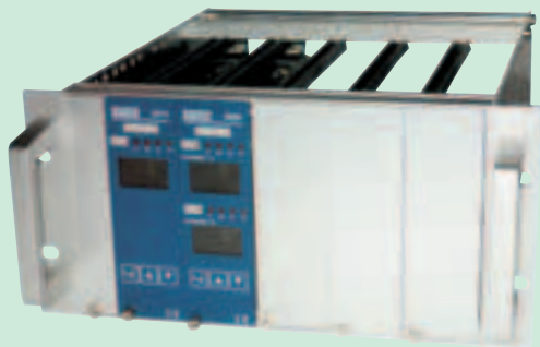
9010/9020 LCD: Baugruppenträger zur Aufnahme von max. 10 Steuereinschüben 9010 bzw. 9020 [max. 20 Messstellen] oder als 19"/2-Baugruppenträger für max. 5 Steuereinschübe, bzw. 19"/5-Ausführung für max. 2 Steuereinschübe.
